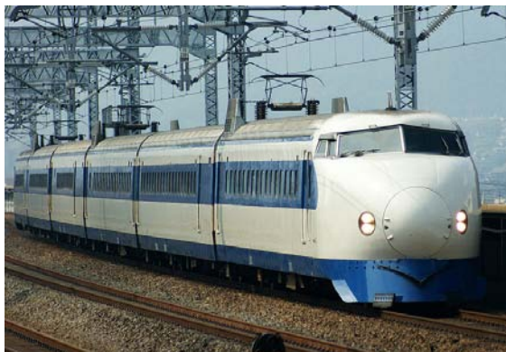
ภาพที่ 2.2 รถไฟความเร็วสูงรุ่นแรกของญี่ปุ่น Shinkansen 0 series
