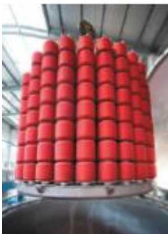
รูปที่ 2.3.3 เครื่องจักรสำหรับการย้อมผ้า
