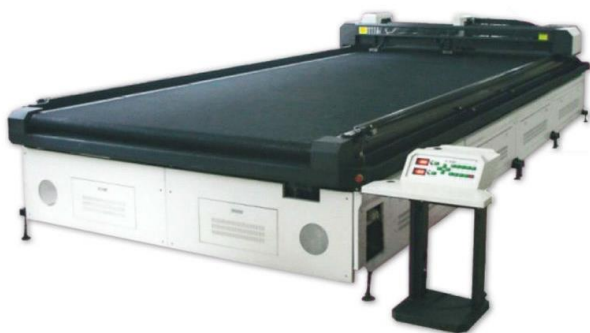
รูปที่ 2.3.4 เครื่องตัดผ้าในโรงงานอุตสาหกรรมเสื้อผ้าสำเร็จรูป
