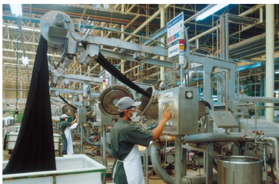
ภาพที่ 4.9 เครื่องจักรการย้อมผ้าในโรงงาน
