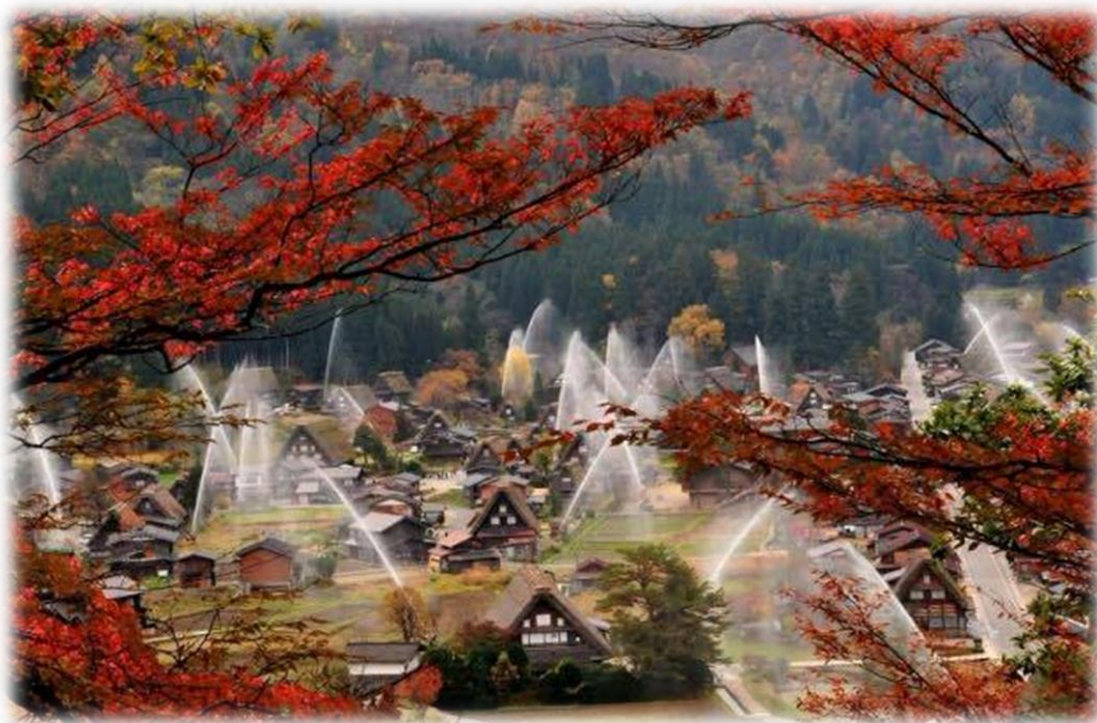
รูปที่52: การฉีดน้ำขึ้นไปบนหลังคาเพื่อป้องกันไฟไหม้ ที่มา: http://samurai-japan.co , (2559)
