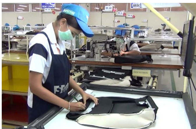
รูปที่ 10 การตรวจสอบหนังหุ้มเบาะที่เย็บเสร็จแล้ว
