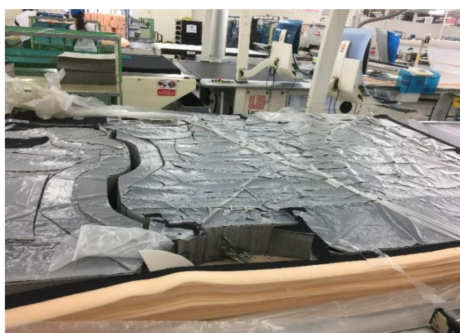
รูปที่ 8 Pattern ที่วาดไว้ก่อนเริ่มทำการตัดด้วย NC cutting
