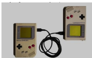
ภาพที่ 4.15: สายเชื่อมต่อสายไฟสำหรับ Nintendo Gameboy Advance “Game Link Cable”
