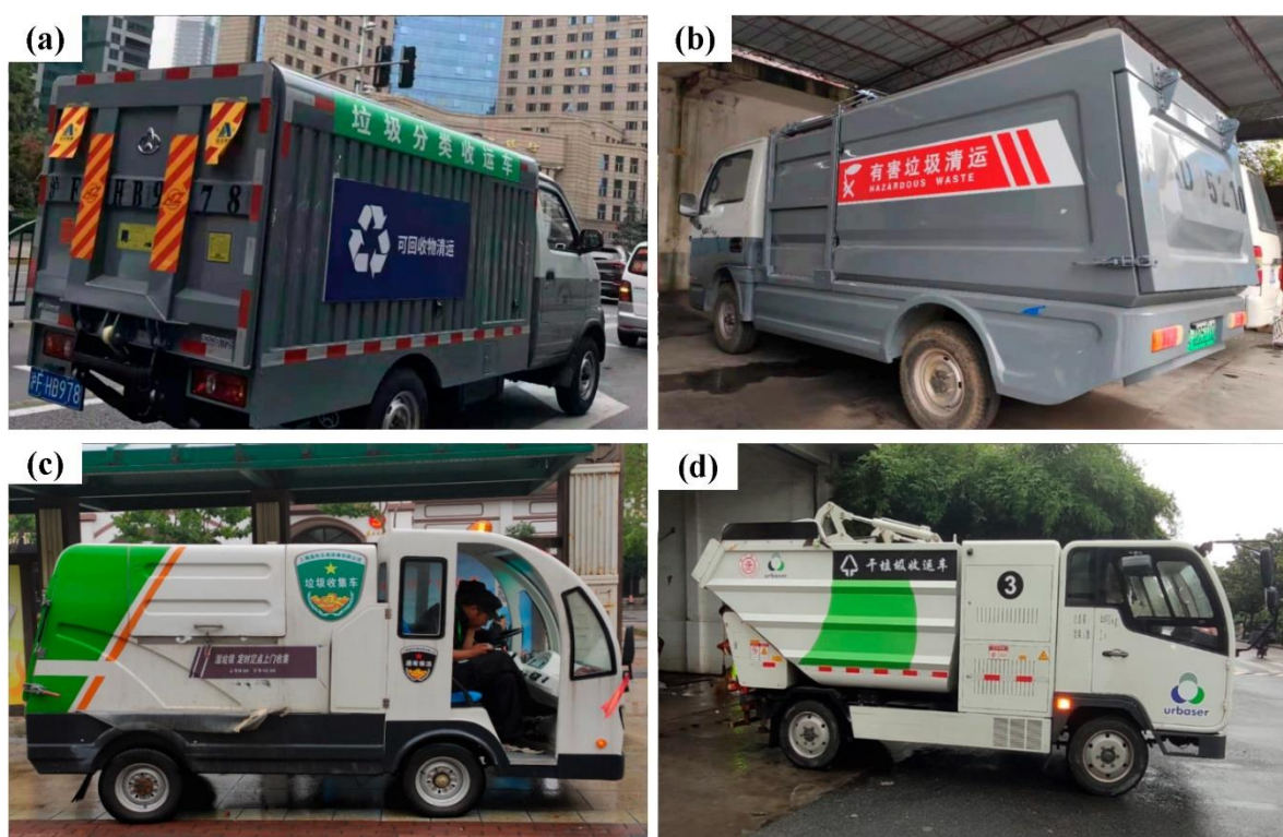
ภาพที่ 4.6 รถขนส่งขยะแต่ละประเภท : (a) ขยะรีไซเคิล, (b) ขยะอันตราย, (c) ขยะเปียก, (d) ขยะแห้ง
